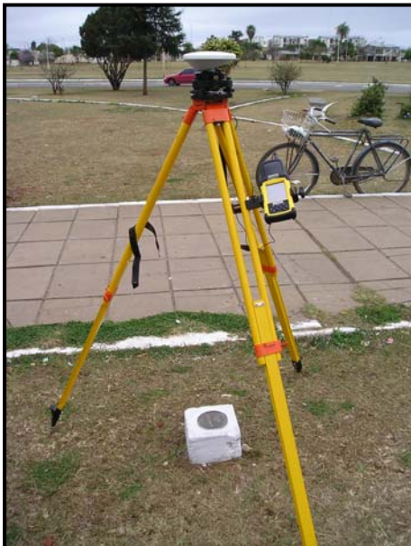
Figura 5.2.2. Estación Base GPS
