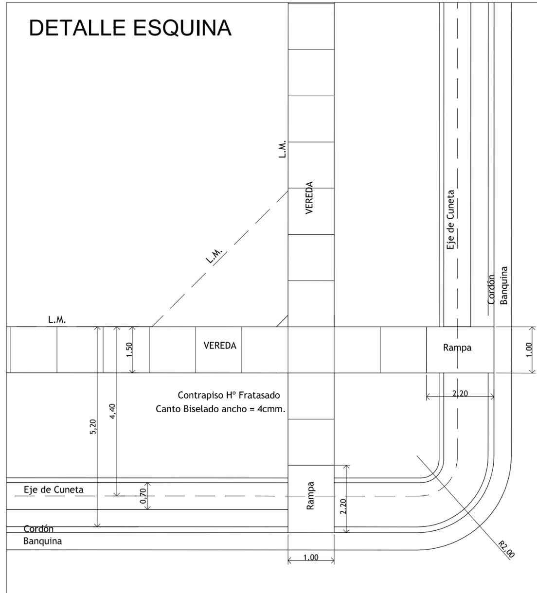
**CONTRAPISOS** Sobre Terreno Natural: se realizarán sobre suelo compactado mecánicamente y nivelado, colocando entre el terreno y el contrapiso una capa de árido grueso y mediano (ripió pelado) compactado de 5 cm de espesor. Se ejecutarán de hormigón simple, con un contenido mínimo de cemento de 300 kg por m<sup>3</sup> de hormigón, H15. Serán de 10cm, con juntas perimetrales de 1 cm de ancho y en paños no mayores de 15 m<sup>2</sup>, rellenas con poliestireno expandido de alta densidad.
