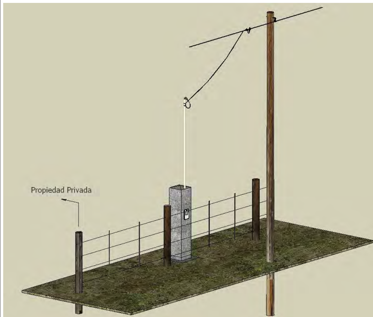
Figura 6: Pilar en zona rural
