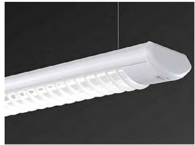
Artefacto de aplicar, accesorios para montaje en línea de 1.20m de 2 tubos con protección Cuerpo: acero tratado con pintura electrostática en polvo. Difusor: louver inyectado, cobertor de policarbonato estriado. Deberán garantizar un mínimo 500lux Iluminante: LED inductor de alto rendimiento SECTOR CONSULTORIOS
