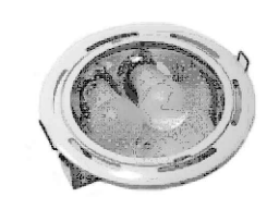
Artefacto empotrable en techo. Para cieloraso tipo armstrong. Óptica louver doble parabólico de aluminio / difusor de policarbonato opal de alto rendimiento. Fabricado en acero esmaltado, terminales ABS. Controlador interno. SECTOR PASILLO
